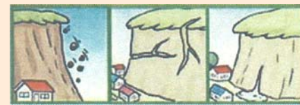
小石の落下 亀裂の発生 湧水の濁り
